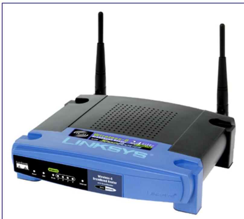
В нем штатно нет возможности подключения флешек, но довольно просто можно впаять SD или MMC карту. Замечу только, что карту перед пайкой лучше отформатировать на компьютере в файловой системе `ext2`, а [GPIO](#) выставлять вручную как в этой инструкции. Я припаял контакты напрямую к карточке, но для сохранения возможности извлекать карту можно использовать гнездо от картридера или переходник `microSD` → `SD`.
