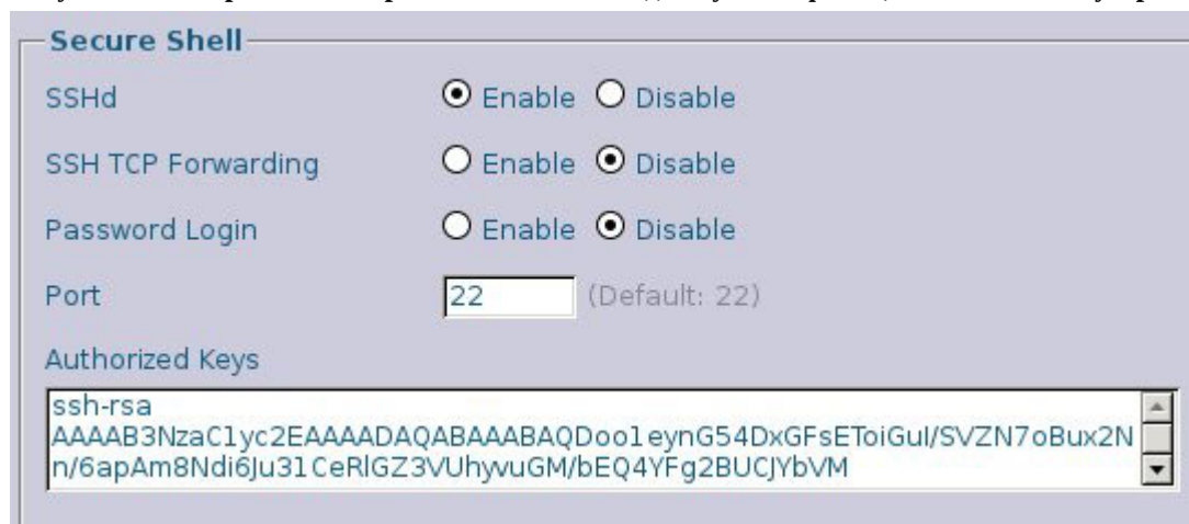
Рисунок 4. Копирование открытого SSH-ключа для аутентификации на DD-WRT-устройстве
